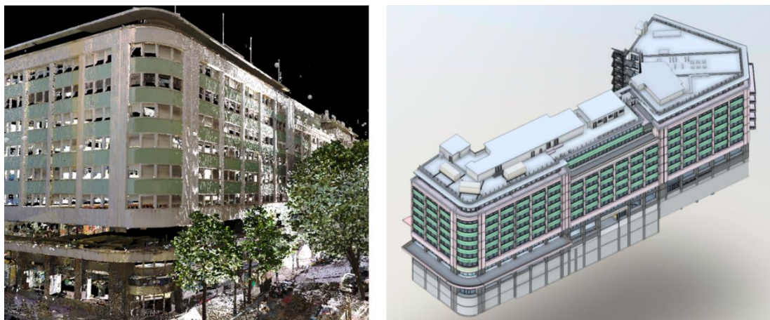
Figura 4: Nuvem de pontos do edifício e respetivo modelo BIM As-Is desenvolvido a partir do levantamento tridimensional.
